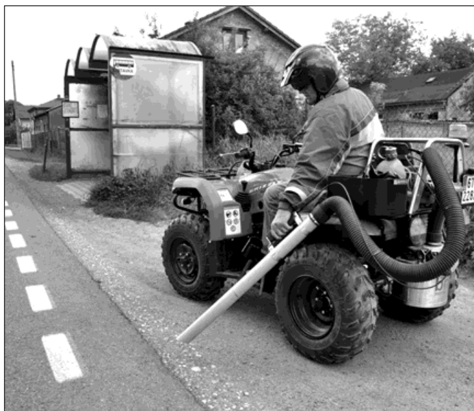
Univerzální vysavač nainstalovaný ve čtyřkolce si poradí i s drobnými odpadky. Foto: Pavel Čempěl
