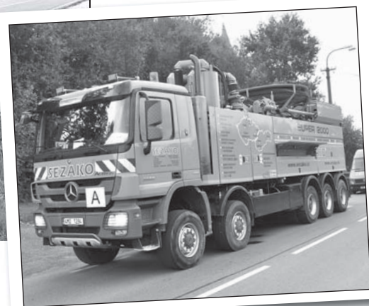
K čištění firma používá speciální vůz se sacím ramenem, které nečistoty nasaje i s vodou. Vodu následně v cisterně odstředí a vrátí zpět do potrubí. Foto: Pavel Čempěl
