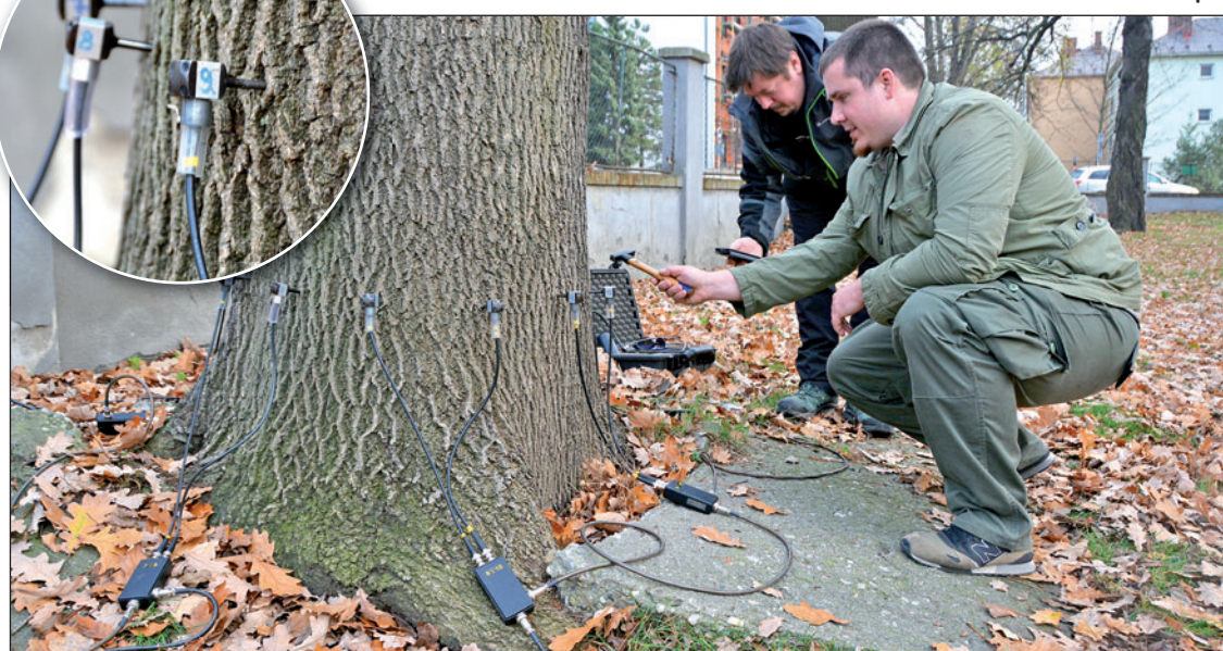
Odborníci v listopadu testovali akustickým tomografem stav vybraných stromů. Po obvodu kmene lze umístit až čtrnáct sond. Foto: Pavel Čempěl
