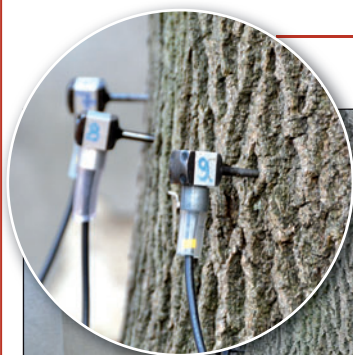
Odborníci v listopadu testovali akustickým tomografem stav vybraných stromů. Po obvodu kmene lze umístit až čtrnáct sond. Foto: Pavel Čempěl
