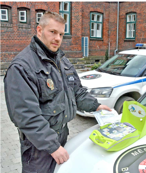
Strážníci mají nově ve výbavě vozu automatický externí defibrilátor. Přístroj sám řídí resuscitaci a navádí záchránce piktogramy a hlasovými pokyny.
