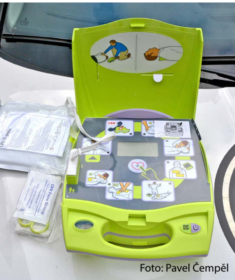
Strážníci mají nově ve výbavě vozu automatický externí defibrilátor. Přístroj sám řídí resuscitaci a navádí záchránce piktogramy a hlasovými pokyny.
